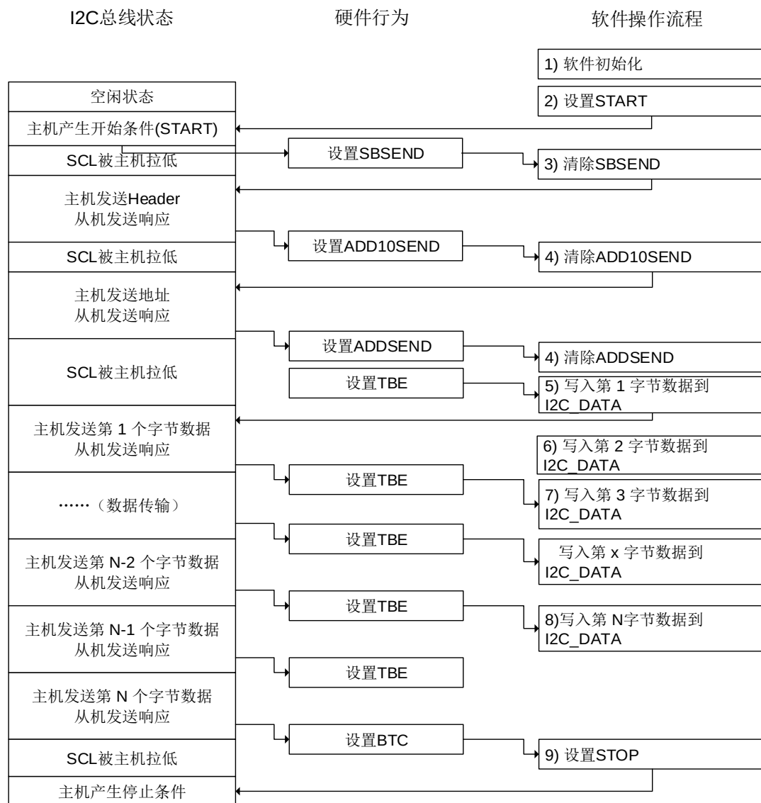
图 17-11. 主机发送模式（10 位地址模式）
